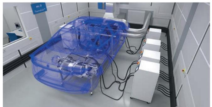
kabine) bei realistischen Fahrzyklen und Umgebungsbedingungen erfolgen. Das AVL ThermalLab™ schließt damit die Lücke zwischen stationären Systemtests und Fahrzeugtests mit Prototypen, wodurch sich Entwicklungszeit und -kosten reduzieren sowie Entwicklungsrisiken minimieren lassen.
