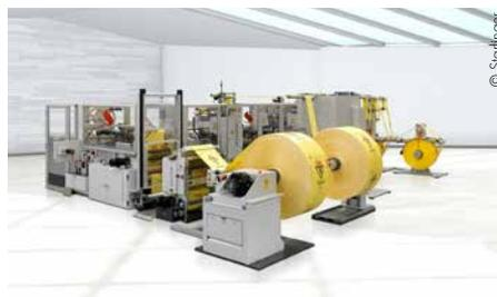
ad\*starKON Sackkonfektionsanlage für die Produktion von AD\*STAR Kastenventilsäcken.
