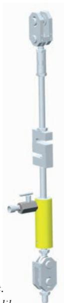
Bild rechts: Der kalibrierte S-Beam-Wägesensor ermittelt präzise die per Hydraulik aufgebaute Druckkraft. Hierdurch ist die Kalibrierung rückführbar auf nationale Normen.
