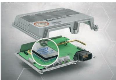
Zudem hat B&R den PC mit 16 GB RAM und 480 GB Flash-Speicher ausgestattet. Damit ist er optimal für rechen- und datenintensive Anwendungen geeignet. Die hohe Rechenleistung ist zum Beispiel für die genaue Pfadplanung einer autonomen Agrarmaschine erforderlich.
