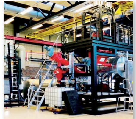
1-MW-Versuchsanlage zur Herstellung von Synthesegas aus Abfall/Gebrauchtholz mit Torrgas B.V. und Pörner als Engineering-Partner in Delfzijl / Niederlande; errichtet wird eine 25-MW-Anlage.
