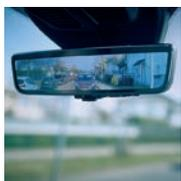
im Inneren des Fahrzeuges weitgehend nutzlos. Um die Fahrzeugsicherheit zu verbessern, hat Ford als Nachrüstlösung nun einen Innenspiegel mit Vollbildanzeige entwickelt. Dieses
