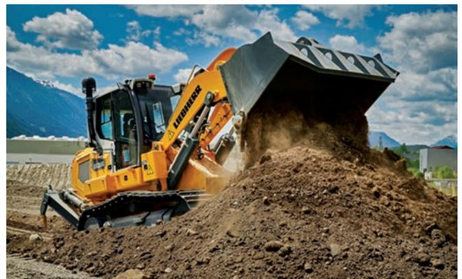
Senkautomatik der Schaufel aktivieren. Diese Funktion ist für Ladearbeiten vorgesehen, bei denen das Hubgerüst wiederholt auf eine bestimmte Höhe gehoben oder gesenkt werden soll. Sobald die eingestellte Position erreicht ist, stoppt die Hub- oder Senkbewegung automatisch.
