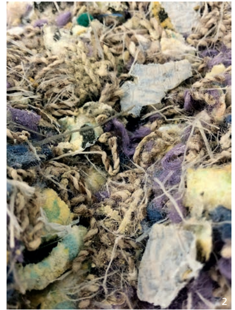
Zerkleinerte Teppichabfälle, die anschließend gereinigt und mit ionischem Liquid versetzt werden.
