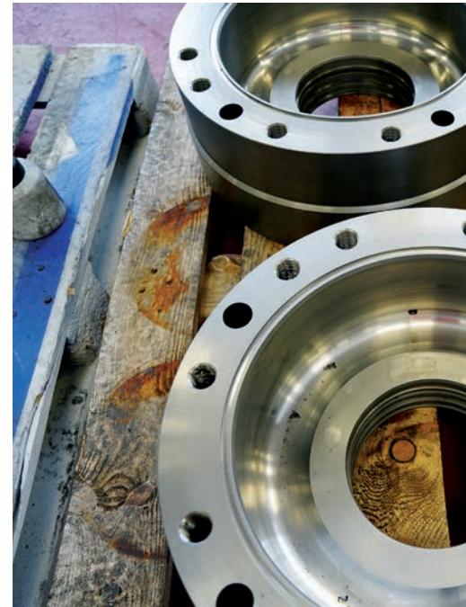
Schneckenspitzen, Plastifiziereinheit, Schwenkscheiben, Hohlwellen bis hin zu Holmen und noch viele weitere Werkstücke werden auf den MILLTURN-Maschinen komplett gefertigt. Alles, was hochpräzise zu sein hat, kommt auf diese Maschinen.
