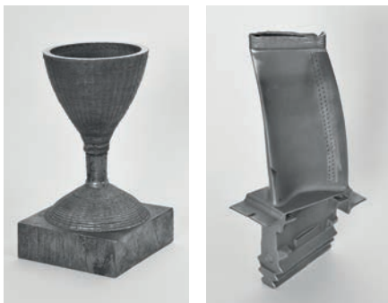
Bild links: 3D-Metalldruck mittels Laser im Pulverstromverfahren; ein frei geformtes Objekt ohne Pulverbett.
