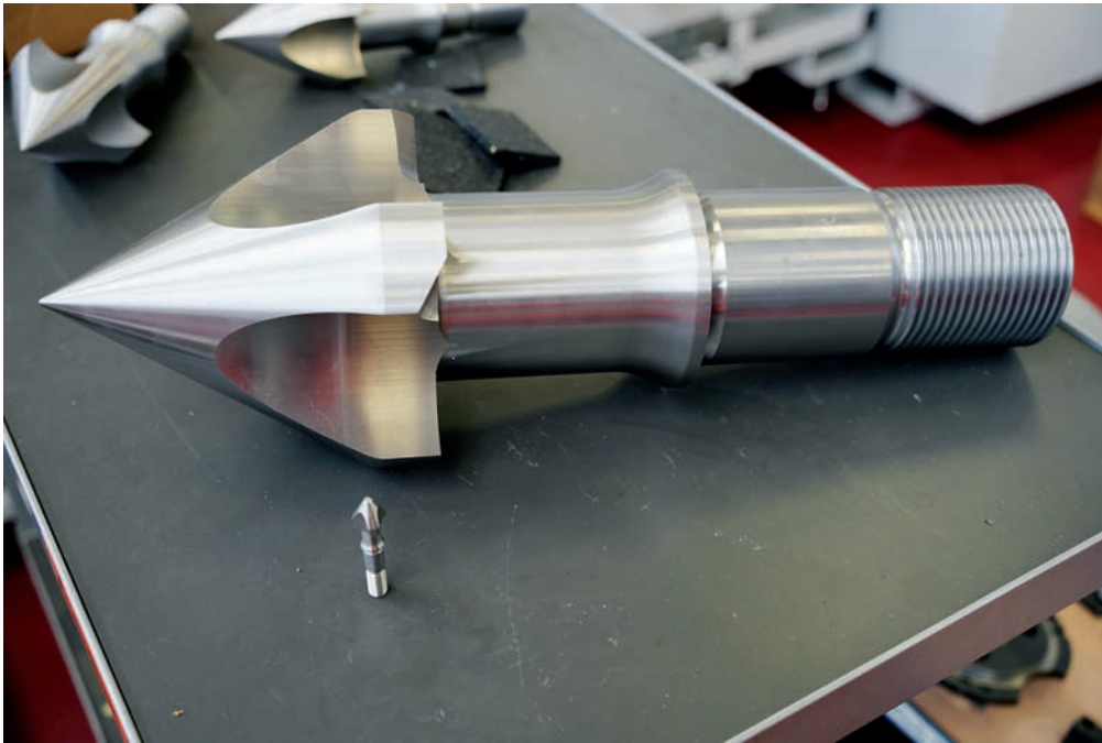
Schnecken spitzen, Plastifiziereinheit, Schwenkscheiben, Hohlwellen bis hin zu Holmen und noch viele weitere Werkstücke werden auf den MILLTURN-Maschinen komplett gefertigt. Alles, was hochpräzise zu sein hat, kommt auf diese Maschinen.
