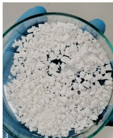
Hochreines Polypropylen aus dem ISOPREP-Prozess.
