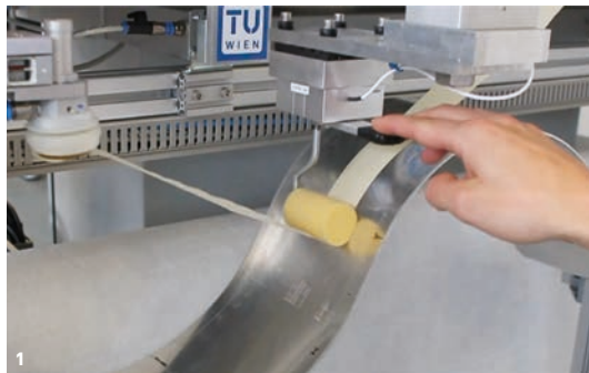
Zusammenarbeit von Mensch und Maschine beim Aufkleben eines Klebestreifens
