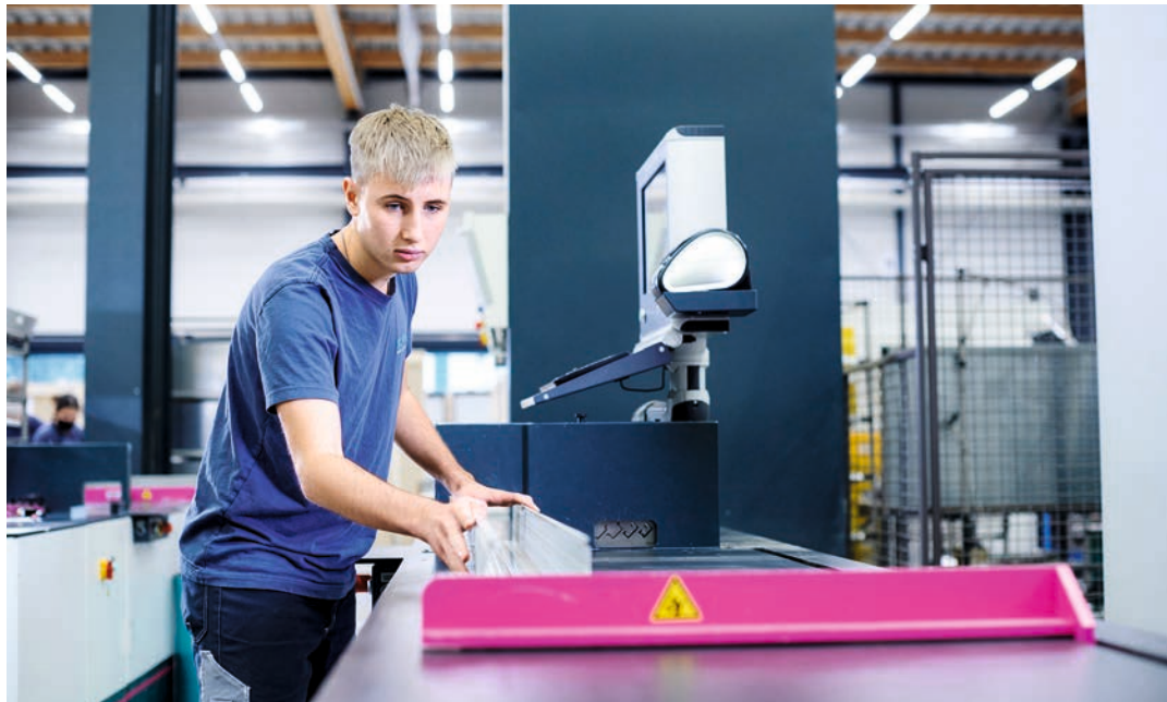
Das Zuschnittcenter Secarex von Rittal langt Verdrahtungskanale inklusive Deckel und Tragschienen schnell, exakt und sicher ab.
