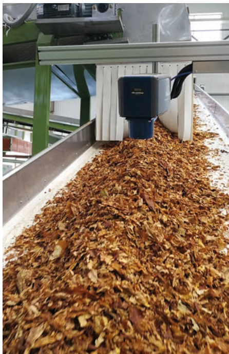
Die NIR-Technologie ist eine berührungslose, wiederholgenaue, drift- und wartungsfreie Messung.
