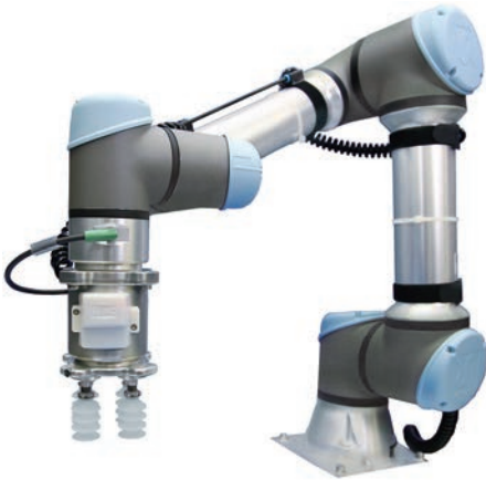
Die Serie ZXP-X1 (hier an einem Cobot) ermöglicht eine schnelle Plug-and-Play-Montage.
