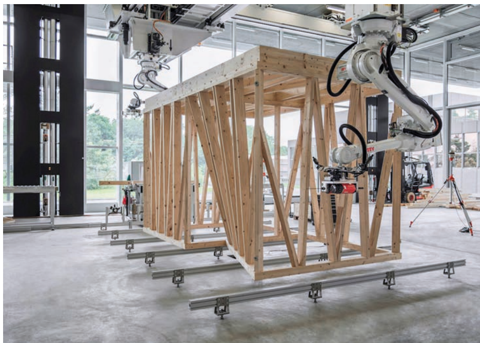
Robotik von ABB kommt auch bei der automatisierten Fertigung von Dachstützen aus Holz zum Einsatz.
