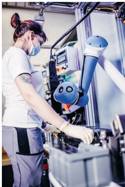
Der Cobot benötigt keine Schutzumhausung.
