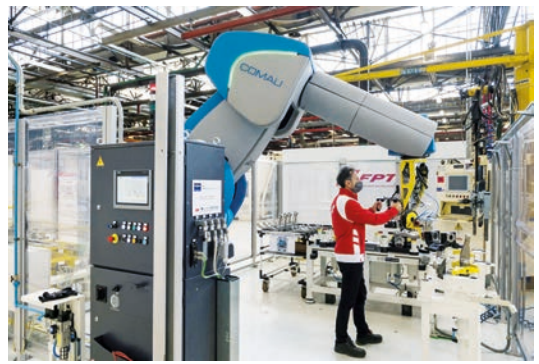
Als kollaborativer Roboter kann AURA die Präsenz einer Person in seinem Arbeitsbereich erkennen.
