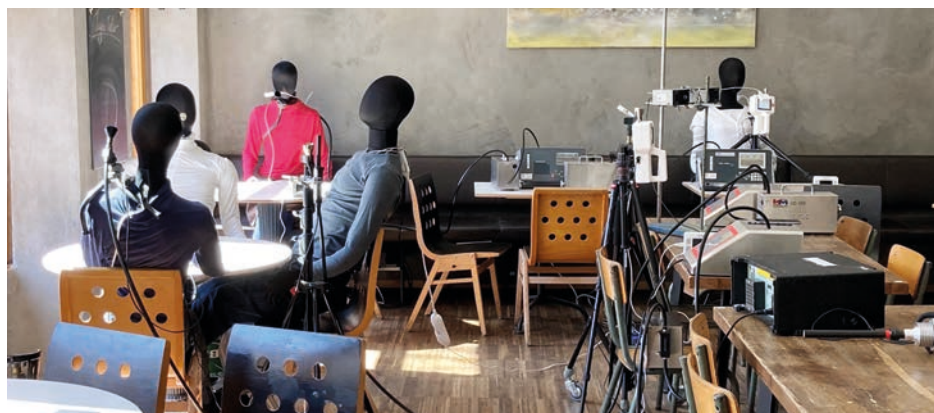
Simulationsmessungen zur Verbreitung von Viren in Innenräumen
