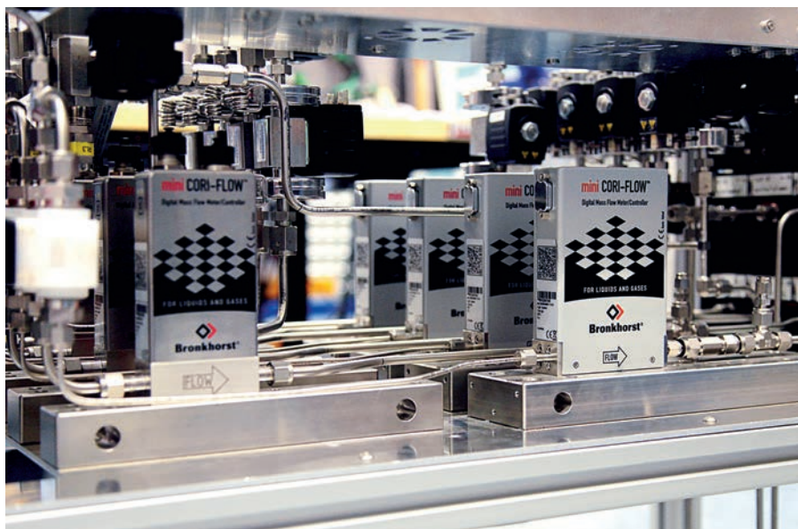
Die mini-CORI-FLOW-Baureihe ist für sehr niedrige Durchflussraten geeignet.
