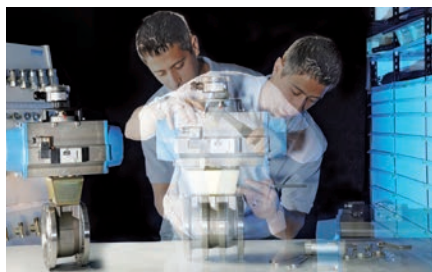
Montage eines Kugelbahns mit pneumatischem Drehantrieb
