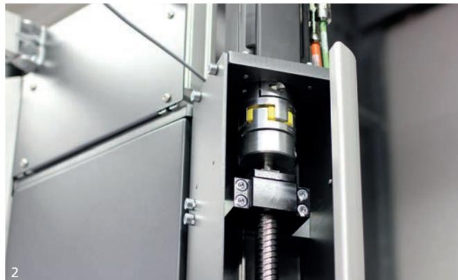
Die horizontalen Holme des lifters werden mittels Kugelspindel-antrieb von TAT bewegt.
