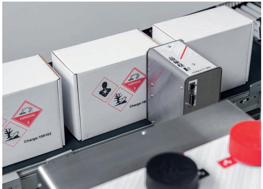
Das Performance-Piezo-Inkjetdrucksystem des Markoprint integra PP 108 kennzeichnet groß, schnell und hochauflösend.
