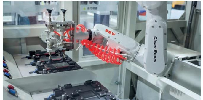
Die nach ISO-Klasse 4 zertifizierte Reinraumvariante des IRB 1300 von ABB hilft dabei, das Risiko einer Kontamination auszuschließen – insbesondere dank chemikalienbeständiger Außenlackierung.
