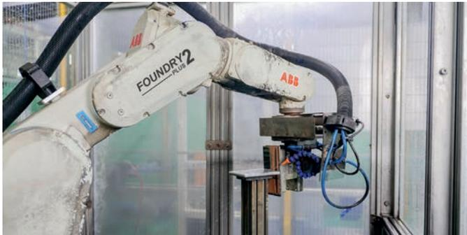
In der Metallverarbeitung sorgt die Ausführung Foundry Plus 2 des IRB 1300 für zusätzlichen Schutz. Denn am Endeffektor kommt hier ausschließlich rostfreier Stahl zum Einsatz. Dies beugt Korrosion vor.
