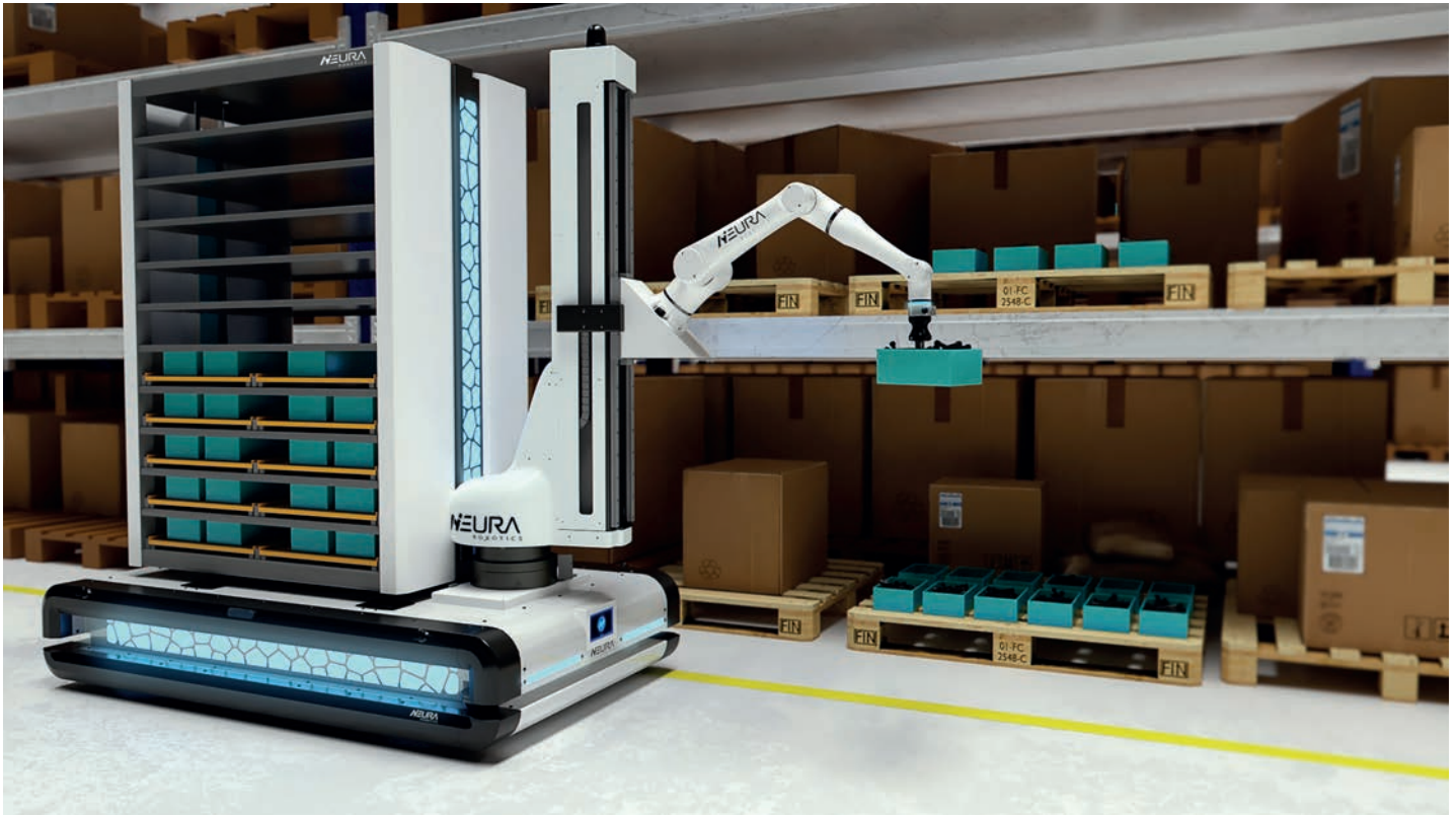
LARA, der Lightweight Agile Robotic Assistant von Neuro Robotics, wurde auf einem Multi-Sensing Autonomous Vehicle, kurz MAV, montiert.
