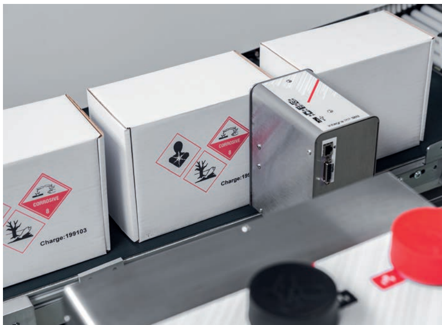
Das Performance-Piezo-Inkjetdrucksystem des Markoprint integra PP 108 kennzeichnet groß, schnell und hochauflösend.
