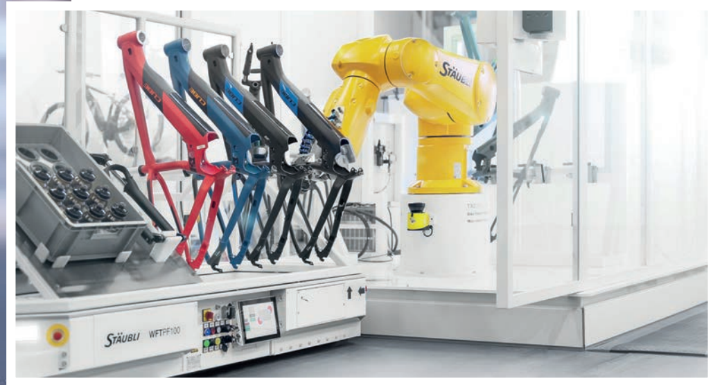
Fahrerloses Transportsystem WFTPF100 von Stäubli WFT navigiert Fahrradrahmen zu neuem TX2-140-Sechssacher zur weiteren Bearbeitung.
