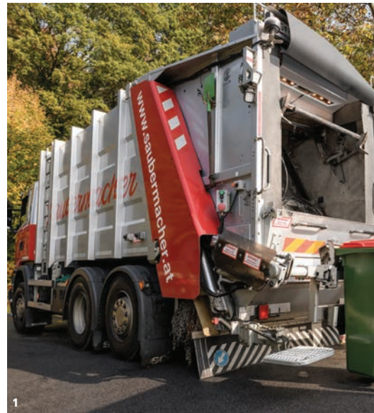
Ein Wertstoffscanner im Sammelfahrzeug erkennt „Fehlwürfe“ im Restmüll.
