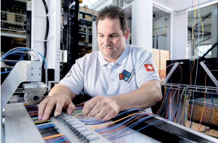
Das Wire Terminal erledigt mehrere Arbeitsschritte in einem Gerät: Ablängen, Abisolieren und Crimpen werden durchgeführt, ohne dass ein Mitarbeiter eingreifen muss.
