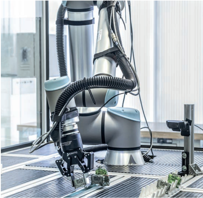
Gemeinsam testeten die Firma Wago und das Fraunhofer IPA in einem Forschungsprojekt, inwieweit sich Standard-Roboterhardware auch für das Aufrasten von Reihenklemmen eignet.
