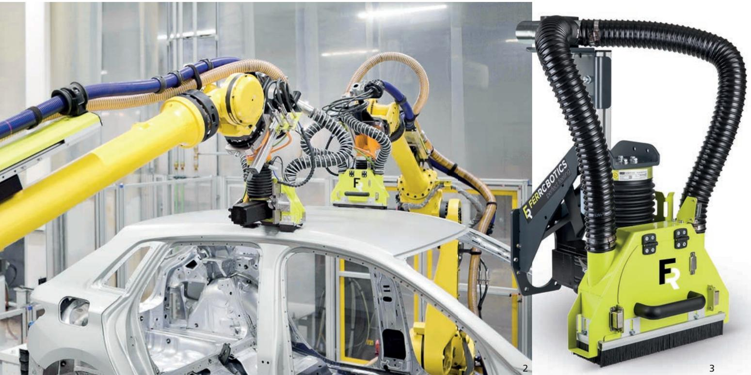
Der ASK hat einen automatischen Toleranzausgleich und arbeitet immer mit der richtigen Kontaktkraft direkt auf der Oberfläche.
