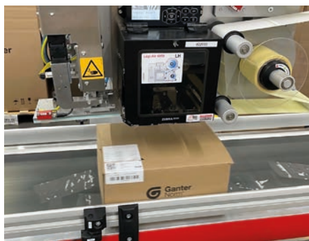
Das Etikettiersystem Legi-Air 4050 E von Bluhm bringt bei Otto Ganter bis zu 80 Etiketten pro Minute berührungslos auf die Produktoberflächen.
