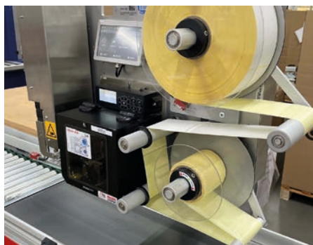
Das Etikettiersystem Legi-Air 4050 E von Bluhm bringt bei Otto Ganter bis zu 80 Etiketten pro Minute berührungslos auf die Produktoberflächen.
