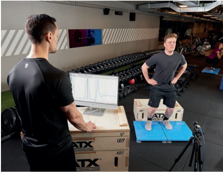
Mit der Kraftmessplatte von Kistler lassen sich selbst kleinste Details, wie Instabilitäten in der Beinmuskulatur, erkennen.
