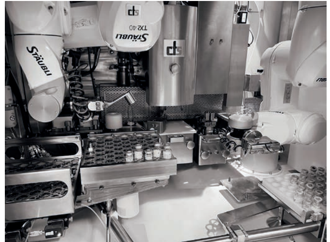
Roboterbasierte Abfüllungs-Unit einer Produktionslinie für radioaktive Krebsmedikation
