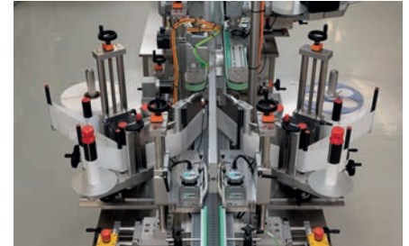
„Tandem-Modus“ mit zwei Systemen auf „halber Kraft“
