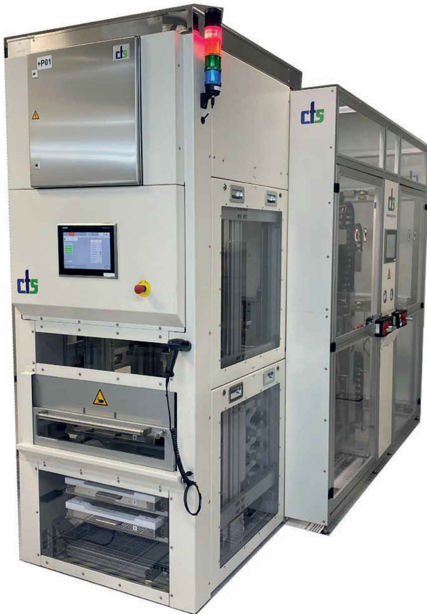
Bagging Unit der vollautomatisierten Auto-Bagging-Maschine für die FOSB-Verpackung
