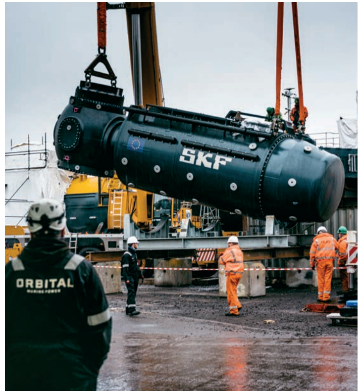
Schwebender Koloss: Einer von zwei Plug-and-play-Antriebssträngen von SKF vor der Montage an den O2-Schiffskörper auf einer Werft in Dundee.
