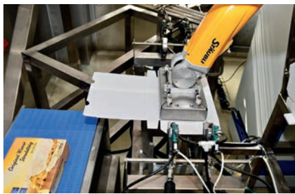
Franz, ein TX2-60L, entnimmt einen Karton aus einem Magazin, führt diesen an vier Leimdüsen entlang und drückt ihn in eine Negativform – fertig ist die Umverpackung.
