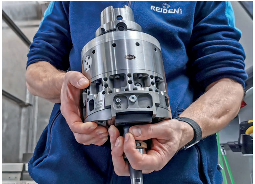
Rechts: Die Tooltronic mit linearem Aussteuerwerkzeug wird über die HSK100-Schnittstelle an der Spindel eingewechselt.
