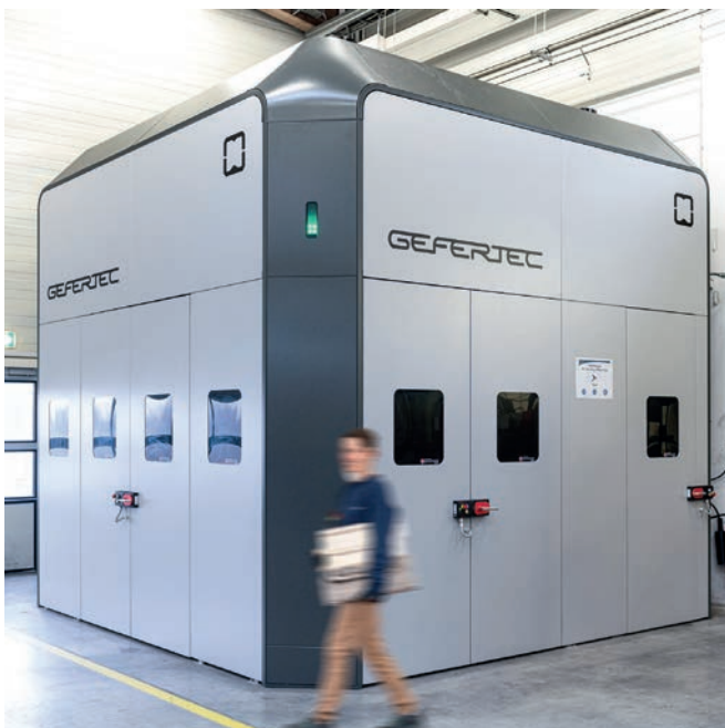
Hochmoderne Anlage zur additiven Fertigung von Bauteilen aus Titan.
