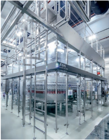
Herzstück der Linie ist der KHS-Dosenfüller Innofill Can DVD, der in Edelstahl bis zu 90.000 Dosen pro Stunde verarbeitet.
