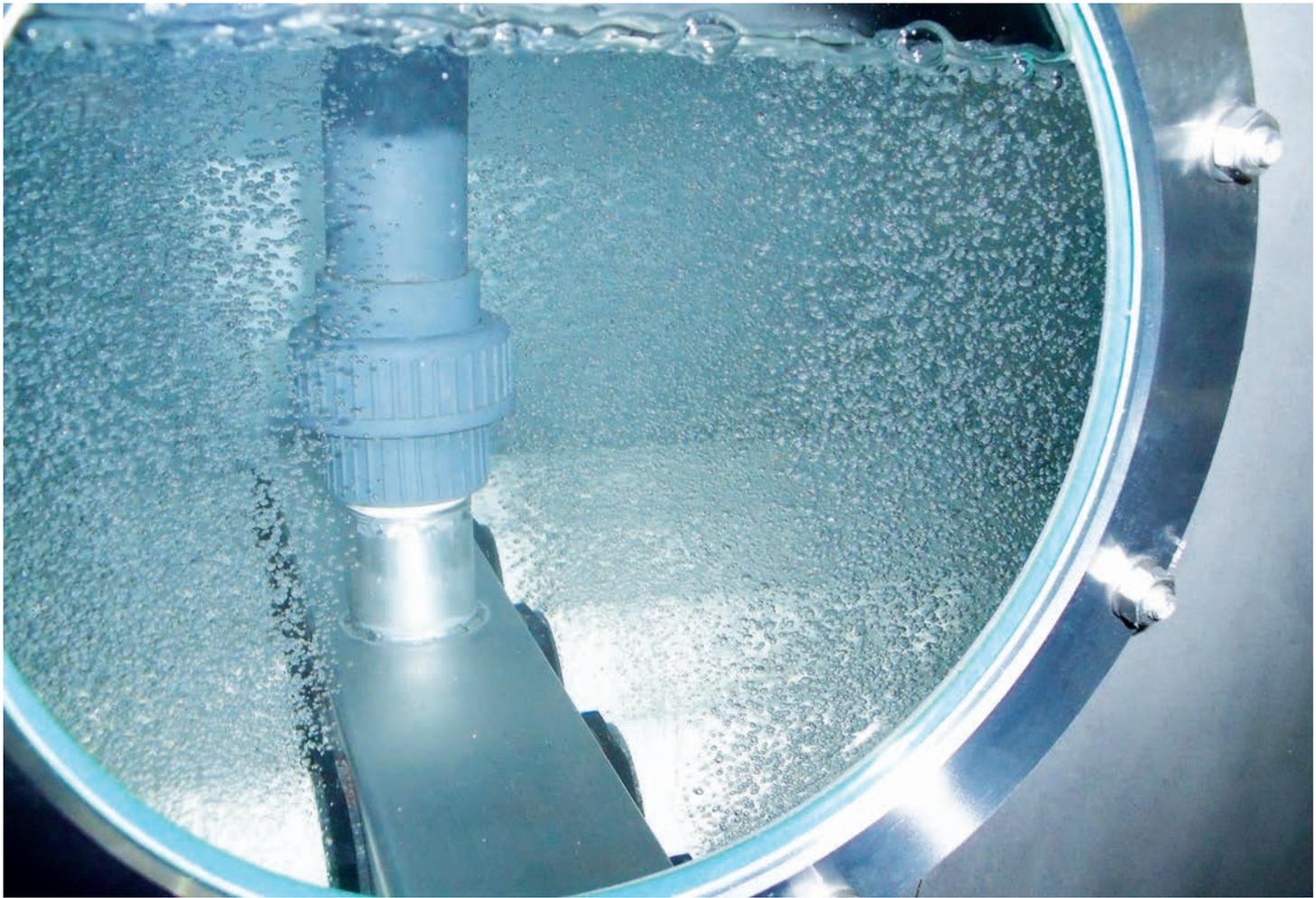
Feinblasige Luftverteilung bei der Wasseraufbereitung
