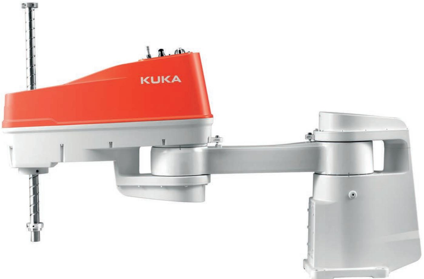
**KR-SCARA-Industrieroboter für Montage- und Fügeaufgaben sowie Pick-and-place-Anwendungen**
