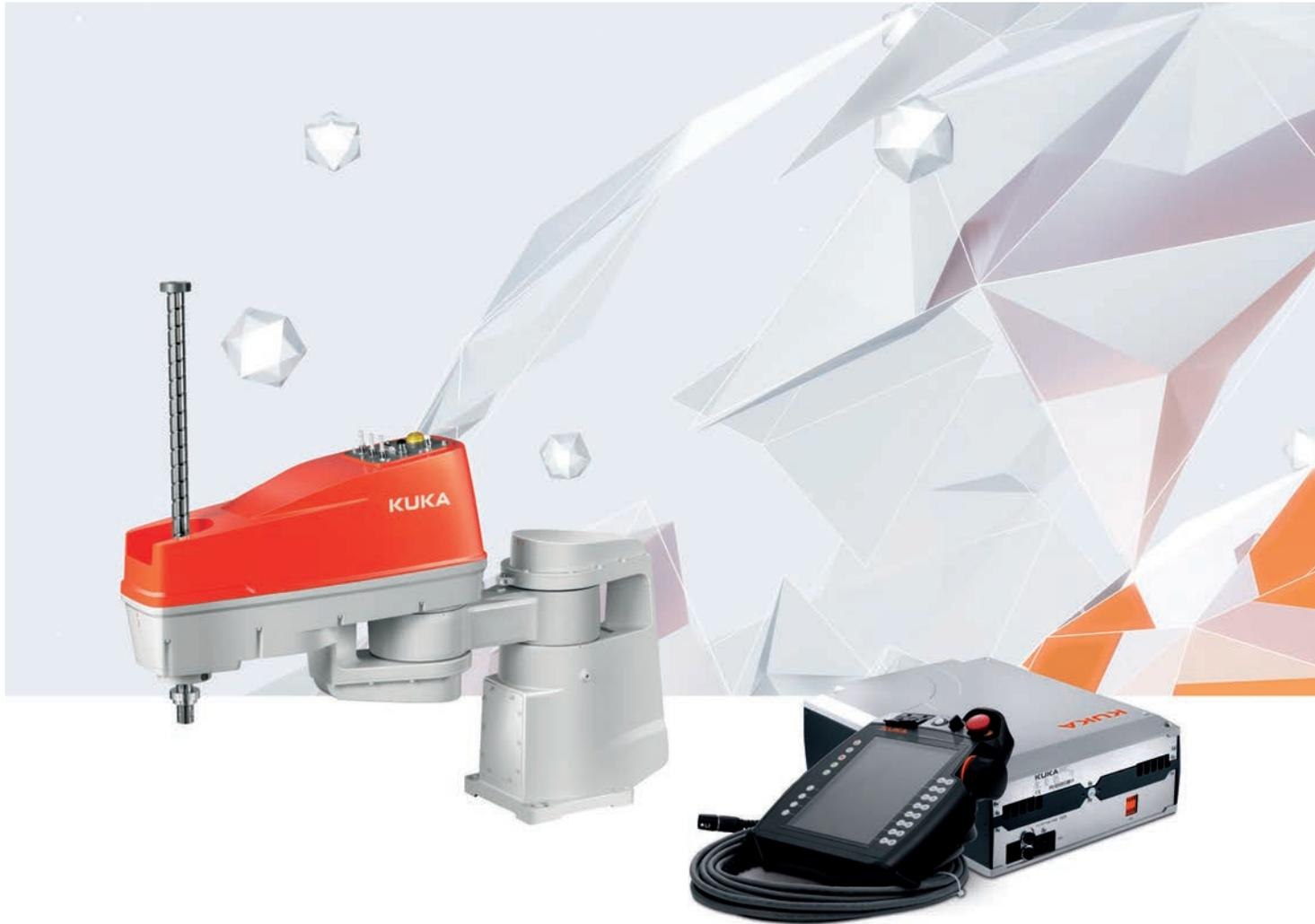
*Der horizontale Gelenkarmroboter in kompakter Bauweise lässt sich leicht in die bestehenden Systeme integrieren und ermöglicht kurze Zykluszeiten, z. B. bei Pick-and-place-Anwendungen.*
