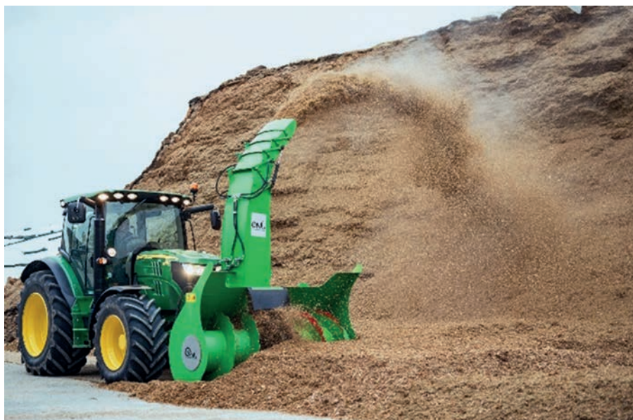
Das patentierte Schleuderrad im Einsatz
