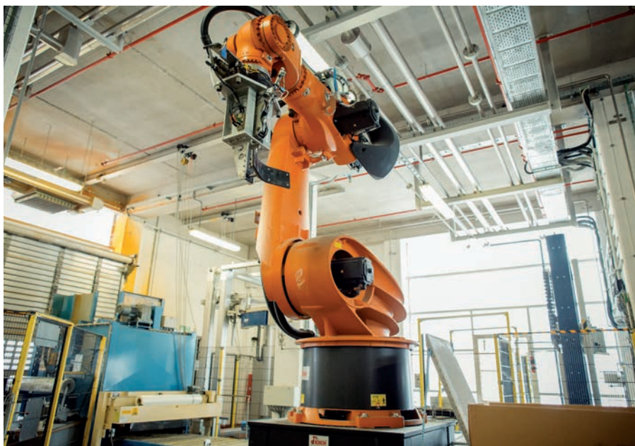
Am BASF-Standort Lampertheim werden Metallfässer vollautomatisch mit Etiketten versehen.
