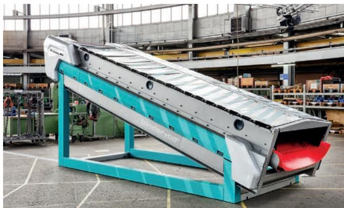
Mag. Jörg Rosegger, Vorstand für Vertrieb und Projektmanagement, und Dr. Martin Pfeffer, Vorstand für Finanzen, Technik und Supply Chain Management (l.). Die Spezialsiebmaschine BIVITEC e+ punktet mit reduziertem Gewicht und niedrigen dynamischen Lasten (r.).
