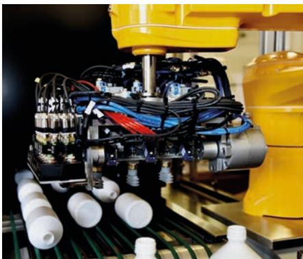
**Ingenieurtechnische Meisterleistung: der Dreifach-Schwenk-Vakuumgreifer, der dem SCARA eine fünfte Achse beschert**
