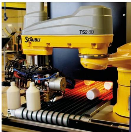
... und legt sie perfekt auf die Geschwindigkeit von Band 2 synchronisiert in stehender Position ab.
