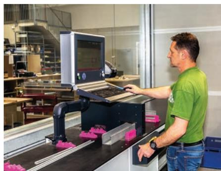
Produktivität und Qualität steigern: Das Secarex-Zuschnittcenter längt Verdrahtungskanäle, Kabelkanaldeckel und Tragschienen schnell, exakt und sicher ab.
