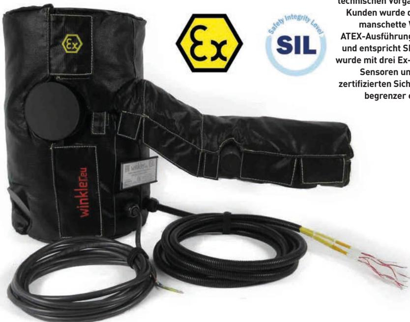
Gemäß den sicherheitstechnischen Vorgaben des Kunden wurde die Heizmanschette WEXH in ATEX-Ausführung gebaut und entspricht SIL3. Dies wurde mit drei Ex-e-Pt100 Sensoren und einem zertifizierten Sicherheitsbegrenzer erreicht.
