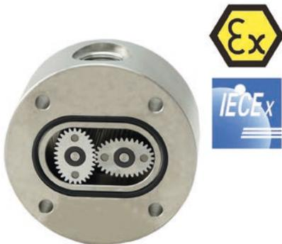
Ovalradzähler sind Verdrängungsvolumenzähler, bei denen sich zwei Ovalräder in einer Präzisionsmesskammer drehen. Mit jeder Umdrehung passiert ein festes Volumen von Flüssigkeit das Messgerät.
