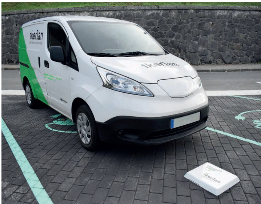
Der entwickelte Prototyp für das kabellose Laden von E-Autos erreicht mit Galliumnitrid-Chips einen Effizienzgrad von 96 Prozent.
