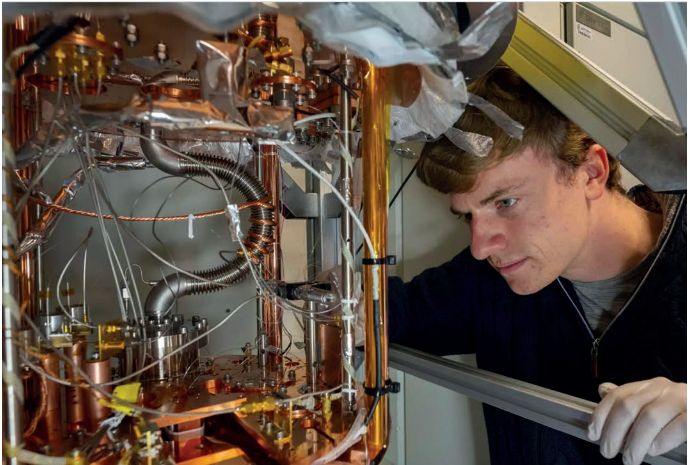
Andreas Gritsch arbeitet an einem zentralen Bestandteil des experimentellen Aufbaus, dem Kryostat.
