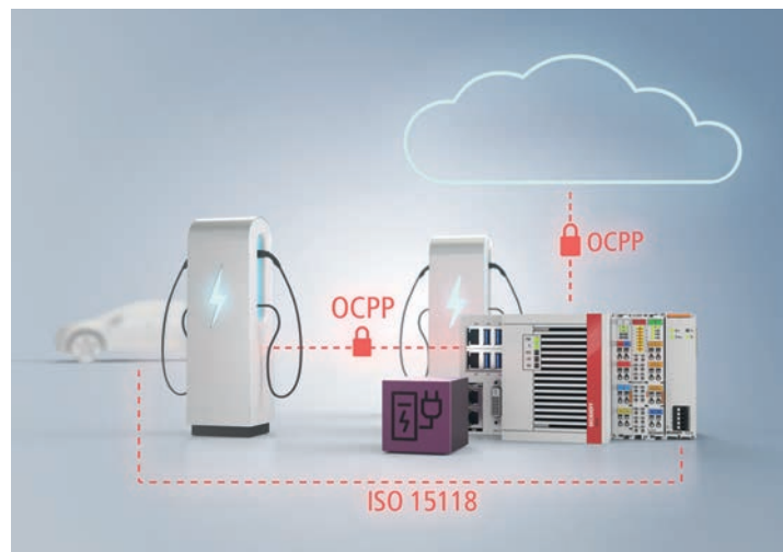
Die EtherCAT-Klemme EL6761 ergibt in Verbindung mit TwinCAT 3 IoT OCPP ein vollständiges Kommunikationssystem für Lade-Infrastruktur-Applikationen.
