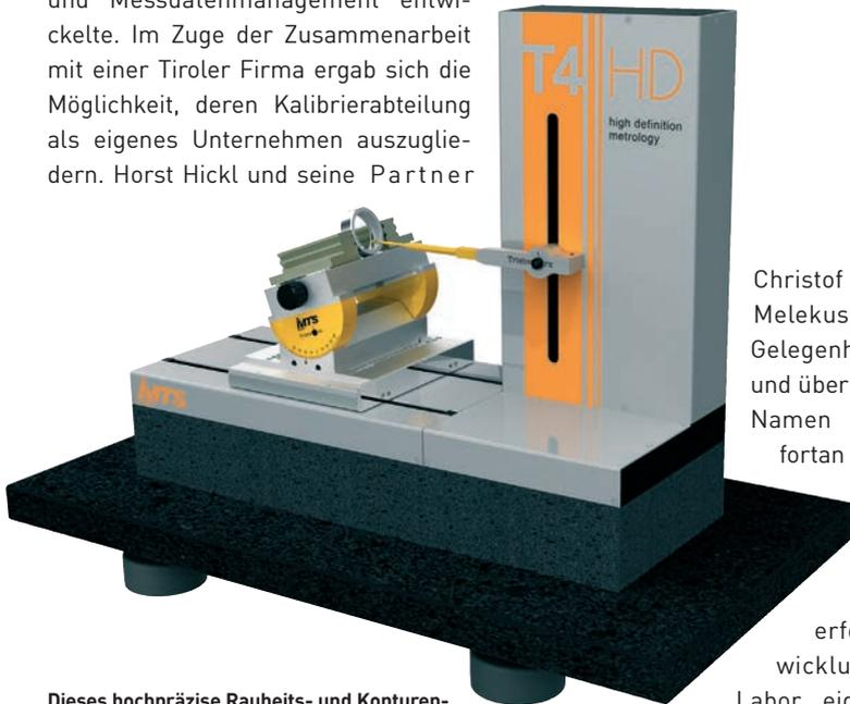
Dieses hochpräzise Rauheits- und Konturenmessgerät verbindet CAD-Zeichnungen mit Form und Lagefunktionen, führt automatisierte Messabläufe aus und übermittelt die Datensätze an übergeordnete Systeme zur Analyse von Fertigungsprozessen. Spezielle Eigenschaften sind Durchmesserbestimmungen ab 0,8 bis 150 mm, Gewindekonturbestimmung, Autokalibrierung, automatische Zenitsuche und verwechslungssichere USB-Tastarme.
