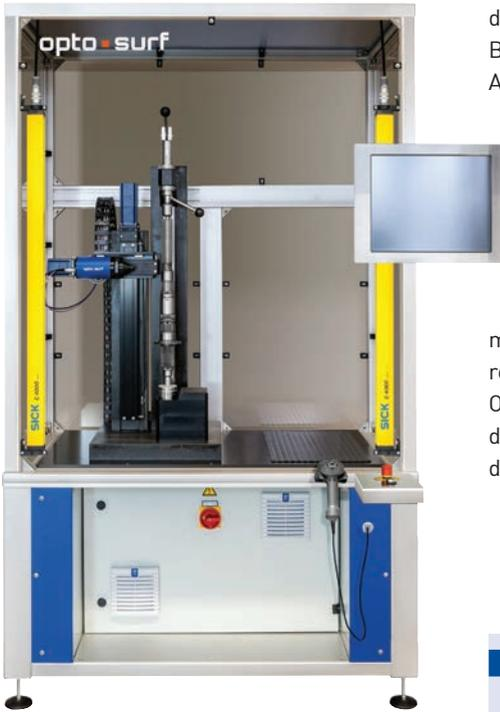
OptoShaft 012 ist eine automatische Messmaschine, die motorisch verschiedene Lager anfahren kann und dort in mehreren Ebenen die Rundheit, Welligkeit und Rauheit messen kann.
