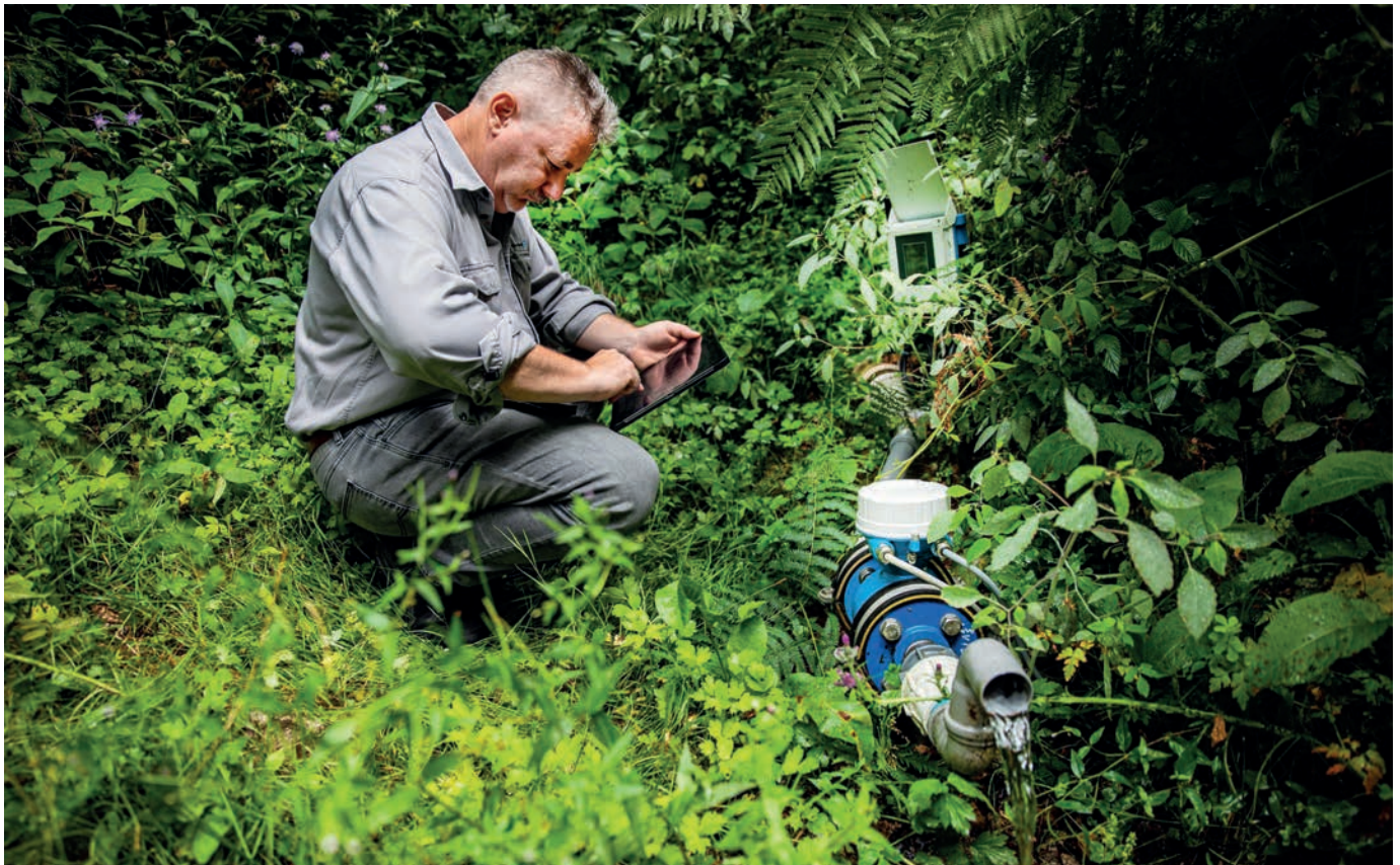
Anwendungsingenieur Ralf Schweigler schaut sich die gemessenen Werte der Quellschüttung am Zeller Blauen auf dem Tablet an. Über den separaten Transmitter des Messgeräts können die Daten auch direkt in eine Cloud gesendet werden.
