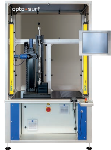
OptoShaft 012 ist eine automatische Messmaschine, die motorisch verschiedene Lager anfahren kann und dort in mehreren Ebenen die Rundheit, Welligkeit und Rauheit messen kann.
