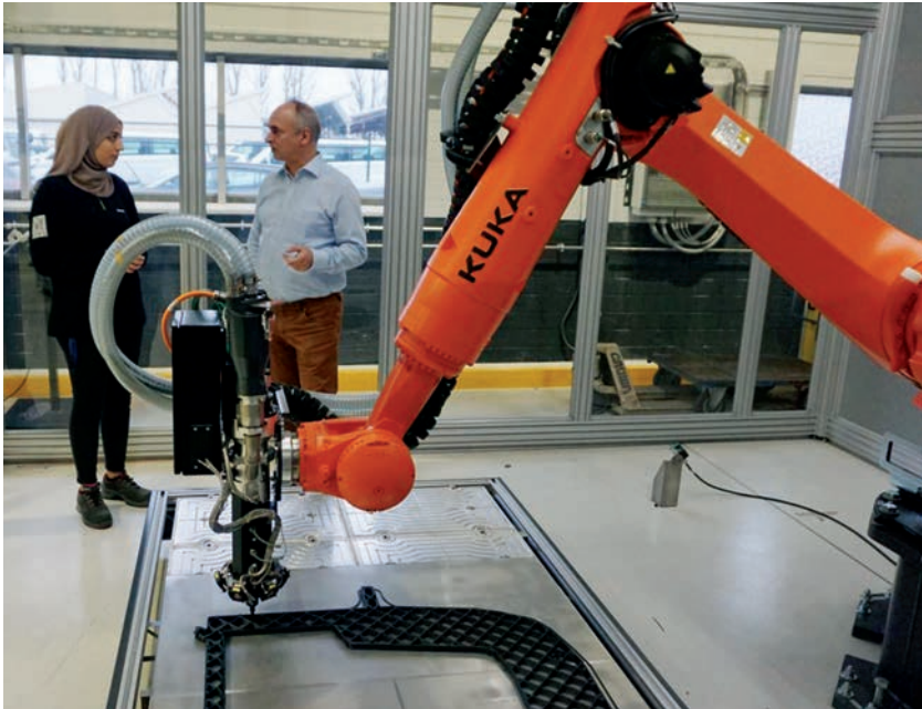
Nurah Al-Haj-Mustafa, Ingenieurin für 3D-Druck bei Ford, und Rene Wolf, Geschäftsführer für Fertigung der Ford-Werke GmbH, begutachten den größten 3D-Drucker im neuen 3D-Druck-Zentrum von Ford in Köln (Bild links). Der größte 3D-Drucker kann Teile bis zu einer Länge von 2,4 Meter drucken (Bild rechts).
