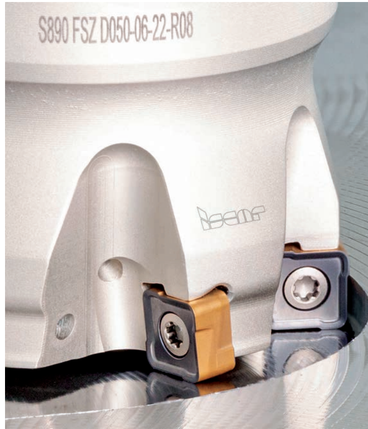
Mit Needo bietet Iscar doppelseitige, quadratische Wendeschneidplatten mit Wiper-Schneide für verbesserte Oberflächengüten beim Schruppen, Vorschlichten und Schlichten.
