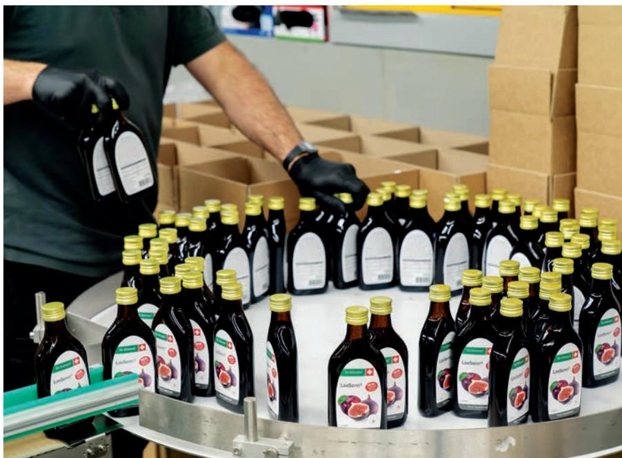
nach Produktgröße arbeitet die Etikettieranlage mit Taktraten von bis zu 120 Produkten pro Minute.
