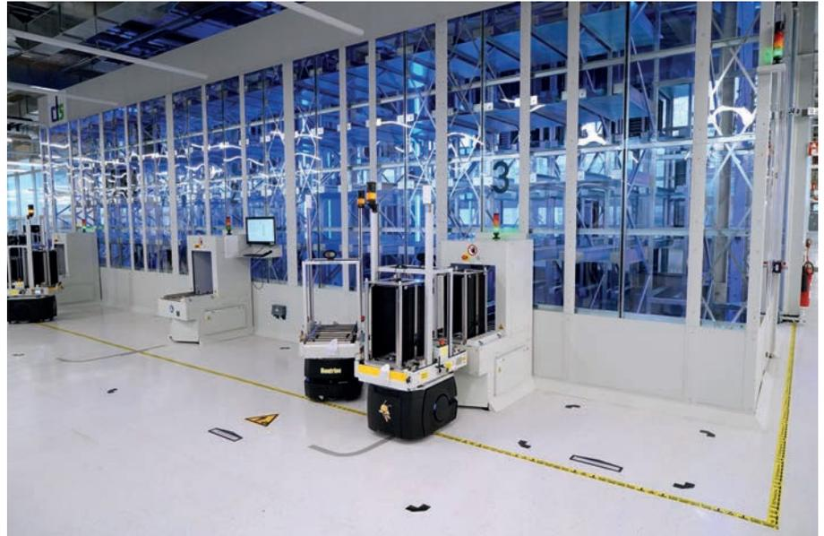
Smart Warehouse für das Leiterplattenmagazin einer Elektronikfertigung – vollständig autonom bedient durch mobile Roboter (AMRs).
