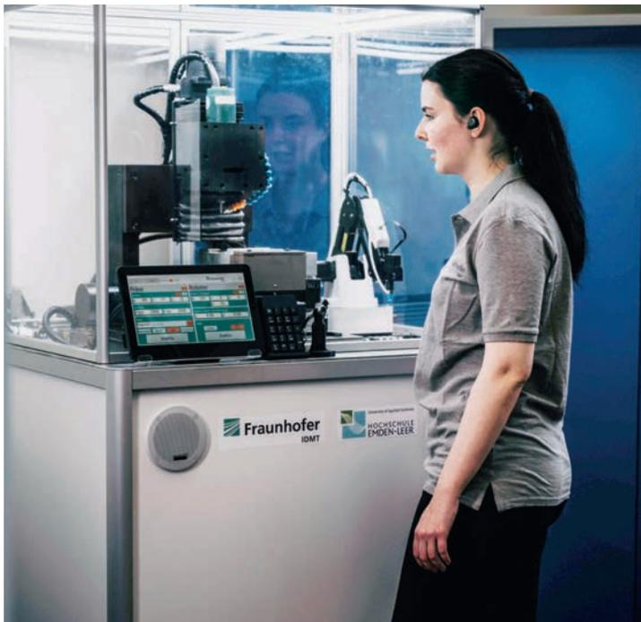
Maschinen wie dieses Fräsbearbeitungszentrum lassen sich über die Spracherkennung und die Audiotechnologie aus dem Fraunhofer IDMT in Oldenburg steuern. Das robuste System ist schnell und einfach an die Bedarfe der Kunden anpassbar.
