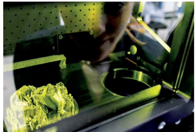
Maschine nimmt mit gerade einmal rund 80 Zentimeter Breite nur wenig Platz ein und lässt sich dadurch auf einfache Weise durch die Tür anliefern und aufbauen. Anwender können auch in kleinen Laboren mehrere Anlagen nebeneinander parallel produzieren lassen und ihre Fertigung noch einmal beschleunigen. Die Bauplatten, auf denen der Zahnersatz entsteht, wechseln bis zu viermal automatisch. Dies ermöglicht die Fertigung von metallischem Zahnersatz auch über Nacht.
