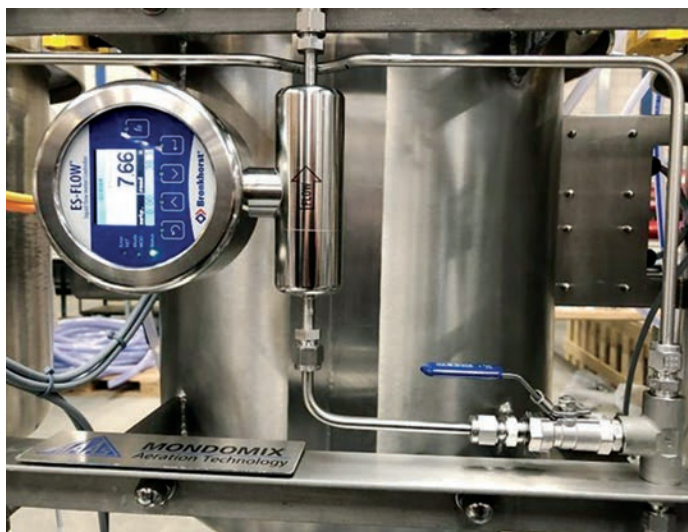
ES-FLOW-Ultraschall-Volumendurchflussmesser zur Messung der Zufuhr von Zusatzstoffen bei der Herstellung von Süßigkeiten
