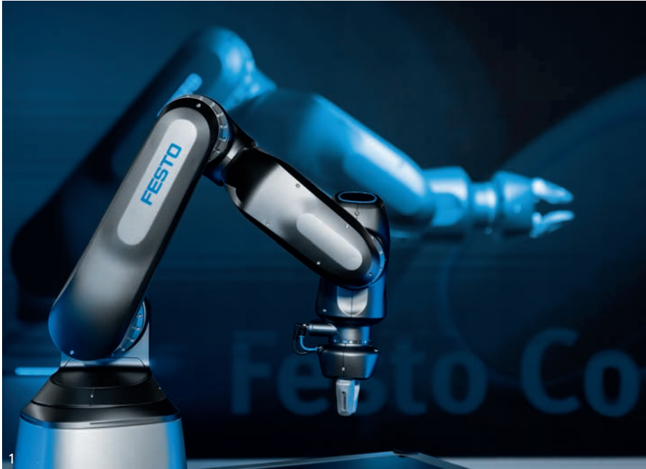
Erster pneumatischer Roboter am Markt: Der Festo Cobot ist leicht zu bedienen, kommt ohne Schutzzaun aus und wird preislich attraktiv sein.
