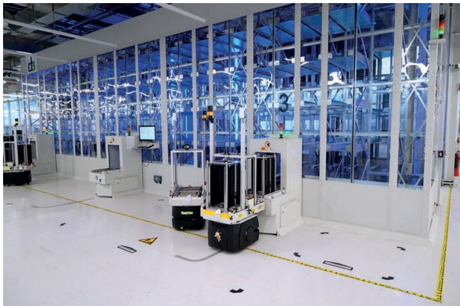
Smart Warehouse für das Leiterplattenmagazin einer Elektronikfertigung – vollständig autonom bedient durch mobile Roboter (AMRs).
