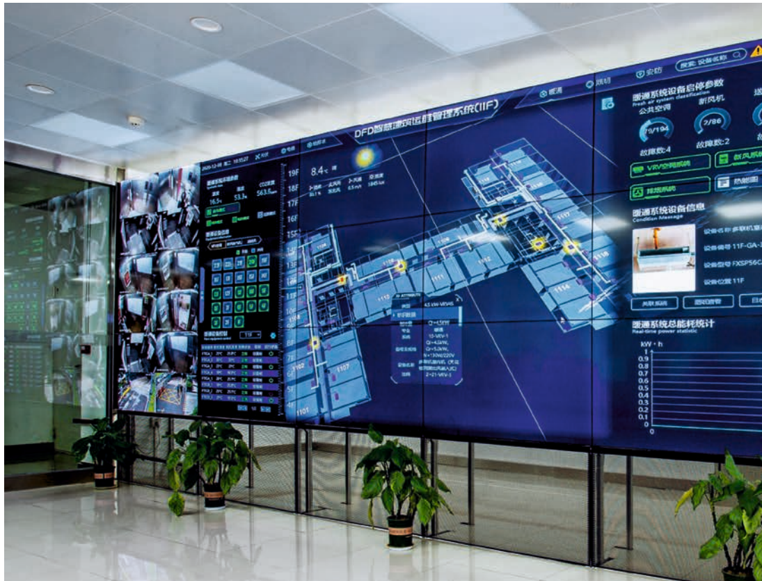
Das vom Dongfeng Design Institute entwickelte Gebäudemanagementsystem umfasst alle relevanten Teilsysteme.
