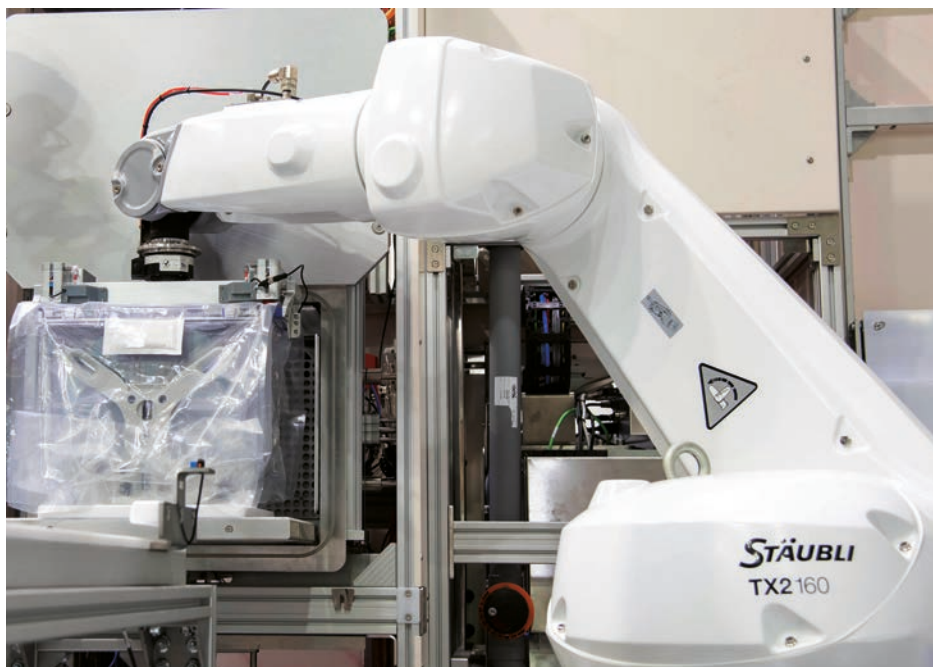
AutoBagging-Tool (ABT) für die vollautomatische Verpackung von FOSB
