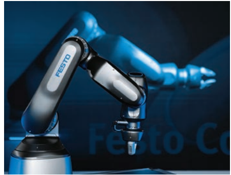
Erster pneumatischer Roboter am Markt: Der Festo Cobot ist leicht zu bedienen, kommt ohne Schutzzaun aus und wird preislich attraktiv sein.
