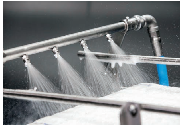
Automatisierte Reinigung eines Förderbandes
