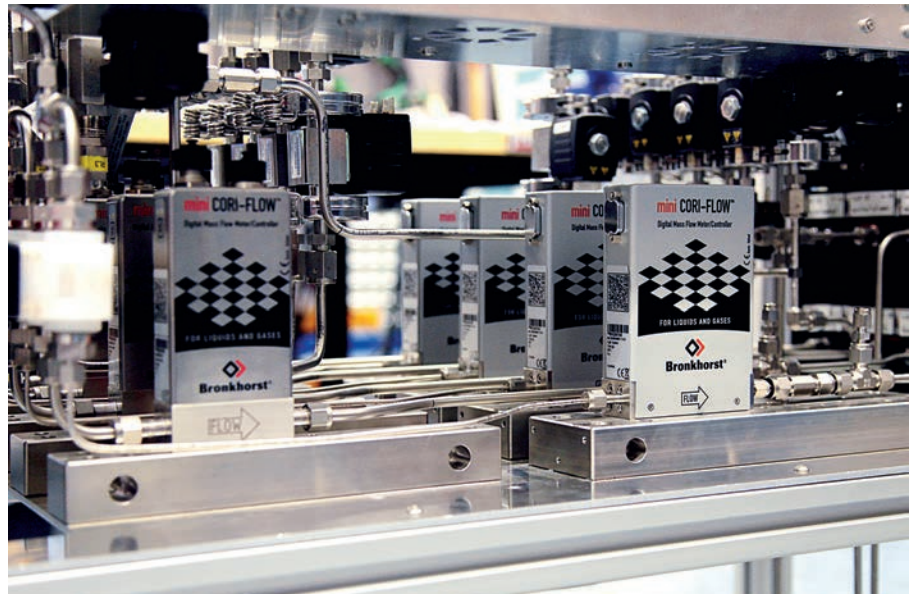
Die mini-CORI-FLOW-Baureihe ist für sehr niedrige Durchflussraten geeignet.
