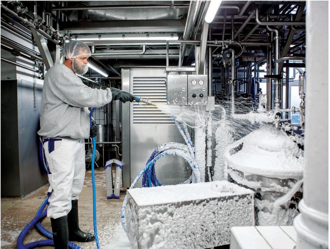
*Manuelle Niederdruck-Reinigung in einem milchverarbeitenden Betrieb*
