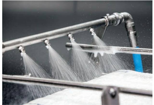
Automatisierte Reinigung eines Förderbandes
