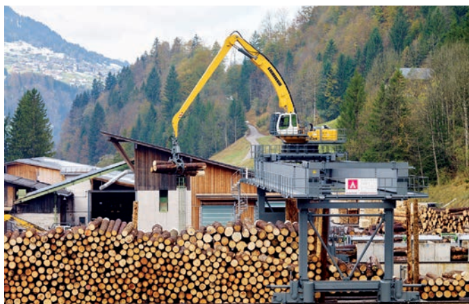
Portalanlage mit Elektrobagger im Sägewerk
