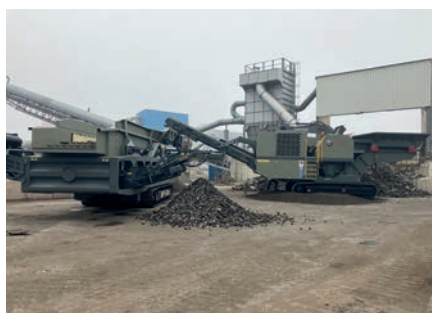
Backenbrecher und Siebanlagen für das Schlackenrecycling aus der Business Unit Aufbereitungstechnik
