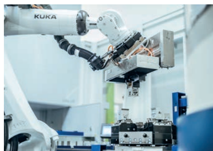
Der Beladeroboter von KUKA spannt vier Werkstücke in die Vorrichtung, um die Fräsmaschine automatisch zu beladen.
