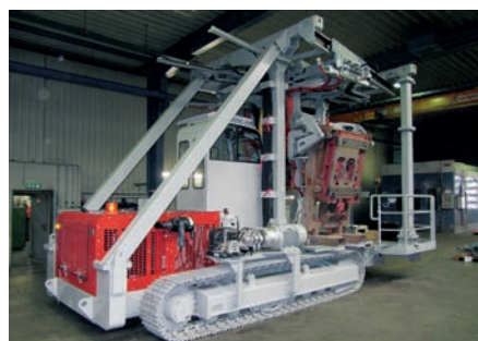
Sonderlösung für Salzgitter Flachstahl: hydraulisch selbstfahrender Schiebermanipulator
