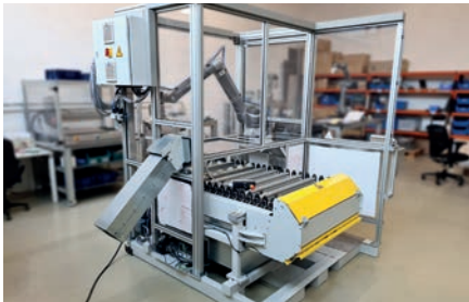
Mobile Automatisierungseinheit von TAT für die Maschinenbeschickung einer CNC-Maschine
