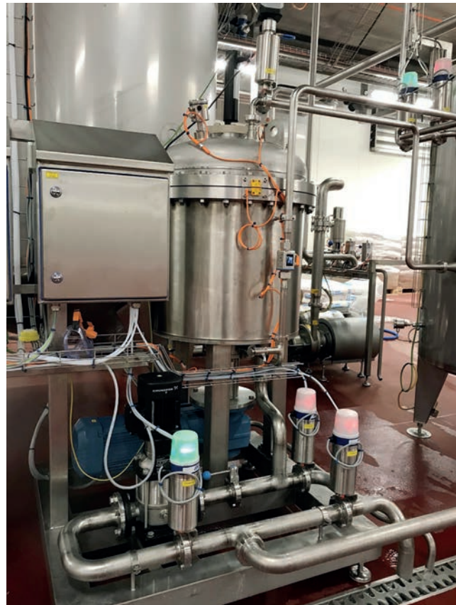
Die Zelix-Strömungstechnik wird als Elektrode zum Aufbau eines Hochspannungsfelds im Filterbehälter benutzt, die Zelix-Membran-Filtermodule als Gegenelektrode. Die innovative Technologie aus Oberösterreich sorgte bereits auf der IFAT 2022 für einen erfolgreichen Messeauftritt.
