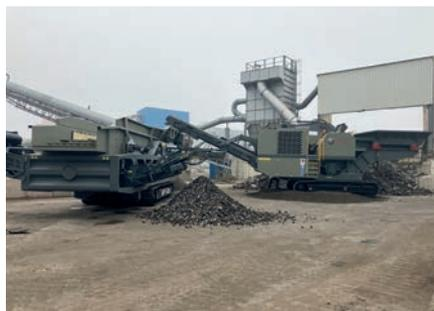
Backenbrecher und Siebanlagen für das Schlackenrecycling aus der Business Unit Aufbereitungstechnik
