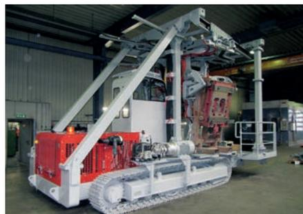
Sonderlösung für Salzgitter Flachstahl: hydraulisch selbstfahrender Schiebermanipulator
