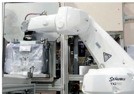
AutoBagging-Tool (ABT) für die vollautomatische Verpackung
