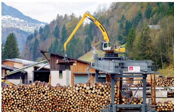
Portalanlage mit Elektrobagger im Sägewerk
