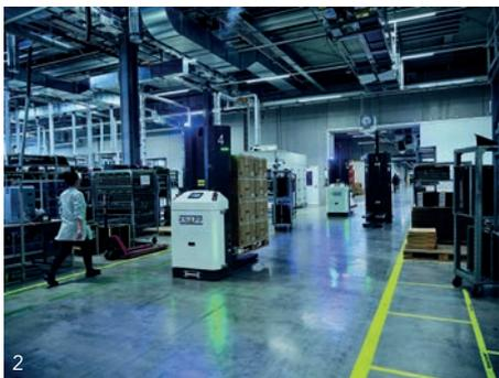
Open Shuttle Fork, autonome mobile Roboter für den Palettentransport, automatisieren die Produktionsversorgung und den innerbetrieblichen Transport von Fronius.
