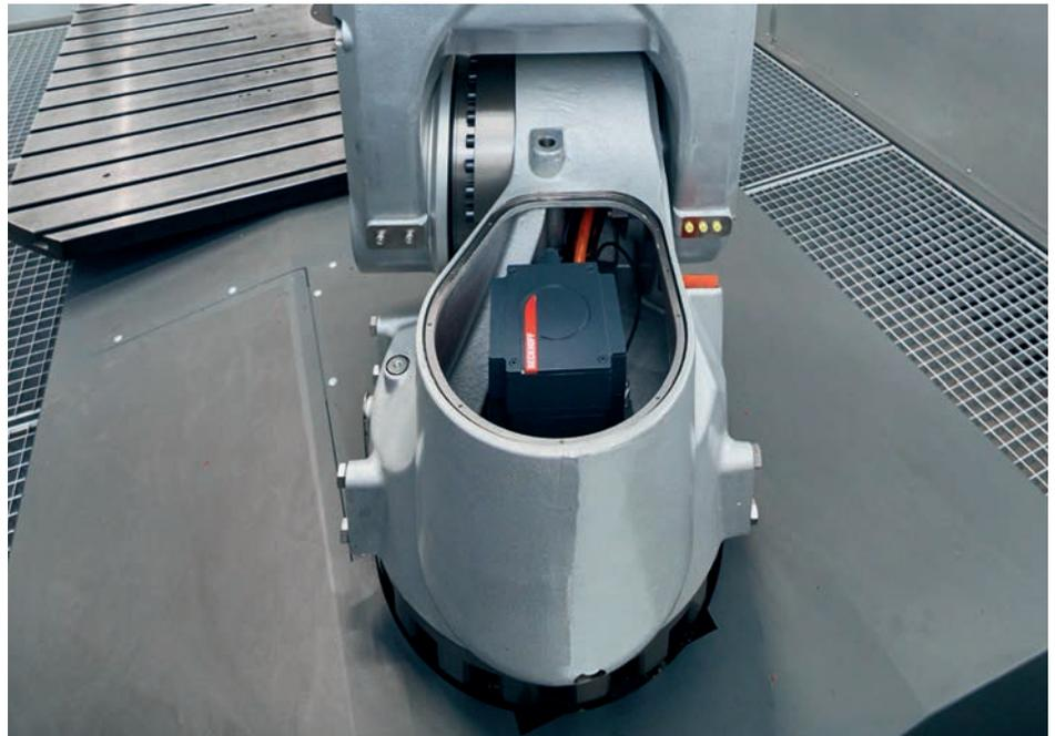
Bedienung und Bahnplanung erfolgen über das kundenspezifische Multitouch-Control-Panel CP3921 wie bei einer 5-Achs-CNC in G-Code (li.). Im Roboter sorgen Beckhoff-Servomotoren AM8000 zusammen mit den an- und abtriebsseitigen Encodern für exakte Bewegungen (re.).
