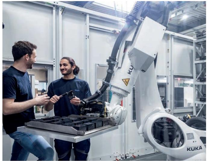
Hermle C400: 5-Achs-Fräsmaschine mit Roboterarm
