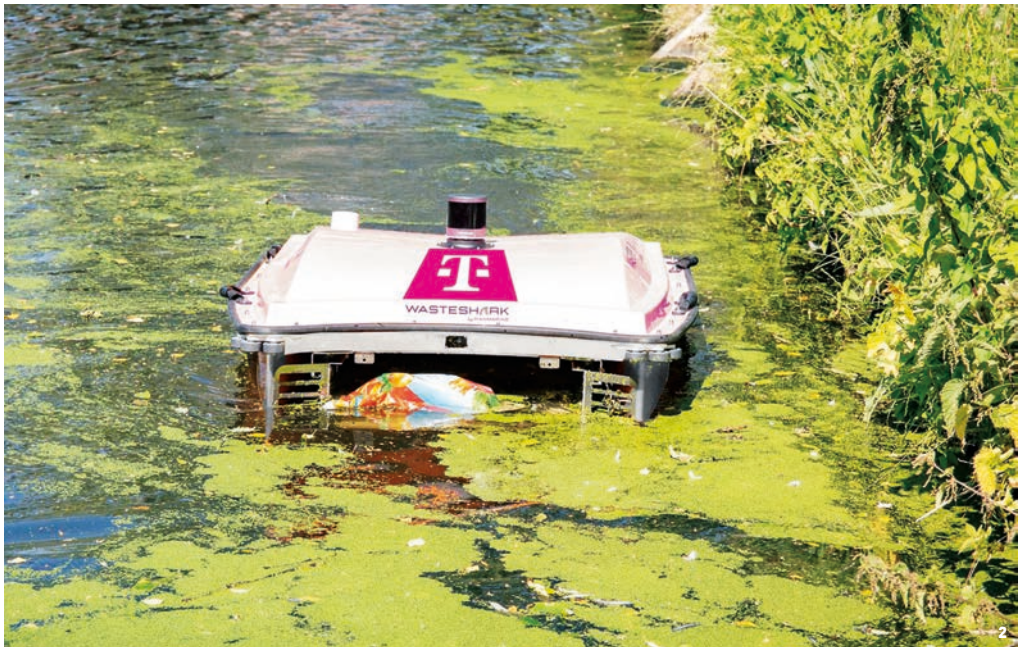
Der Schwimmroboter WasteShark fischt mit hochgenauer Routenführung Müll aus Gewässern.
