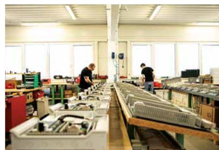
dividuelle Lösungen garantieren zu können. Die mechanische Bearbeitung der Schaltschränke erfolgt durch das Bohr- & Fräscen-Perforex BC 1001. Somit werden Arbeitsschritte wie Bohren, Gewindeschneiden und Fräsen von Ausschnitten optimiert. Spörk fertigt die Anlagen mit höchster Präzision, nach internationalen Standards, Zertifizierungen und Qualitätsvorgaben. Das macht das Unternehmen zu einem verlässlichen Partner im Schaltschrankbau in Österreich.
