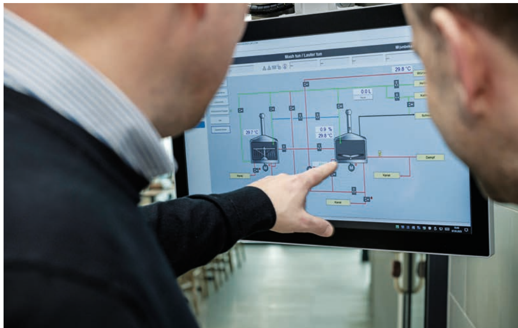
Ein digitaler Zwilling der Brauanlage visualisiert sämtliche relevanten Parameter.
