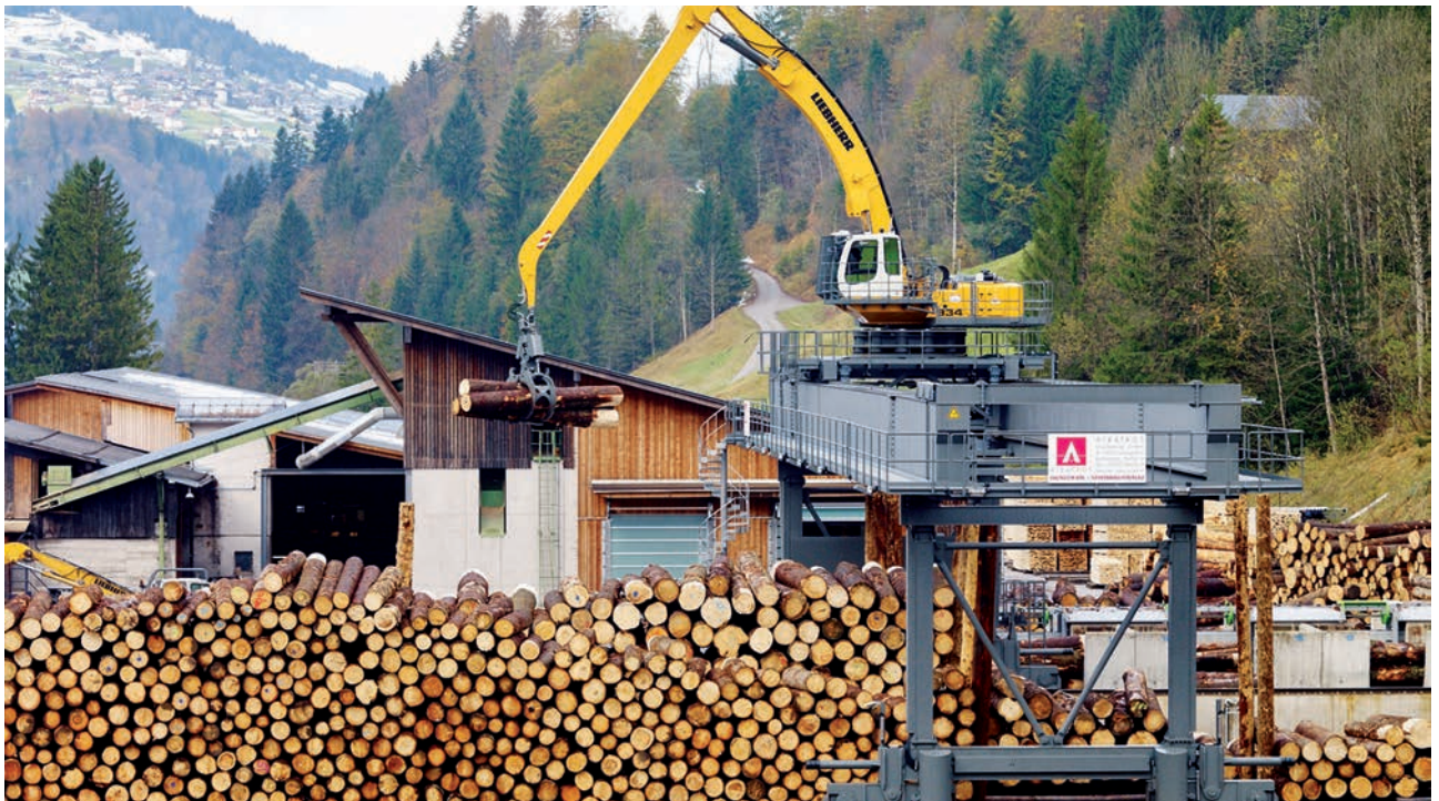
Portalanlage mit Elektrobagger im Sägewerk
