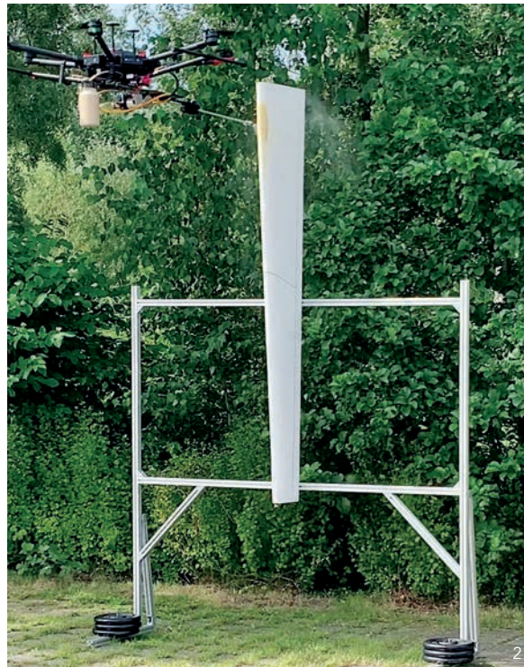
Die Lackierdrohne des Fraunhofer IFAM im Sprühversuch.
