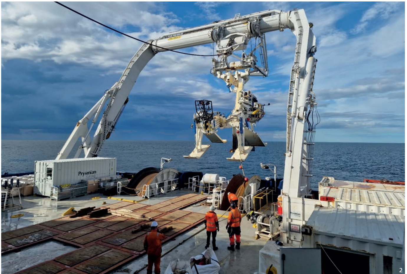
Das Ausrüstungspaket von Palfinger besteht unter anderem aus einem großen A-Frame für Pflugeinsätze.
