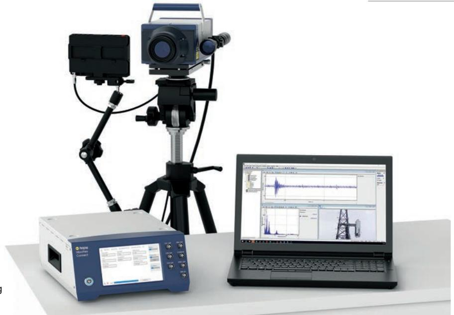
Zuverlässige Präzisionsmesstechnik im Feld: Das Vibrometer ermöglicht Schwingungsmessung und Condition Monitoring mit Laserpräzision sogar aus mehr als 300 m Entfernung.
