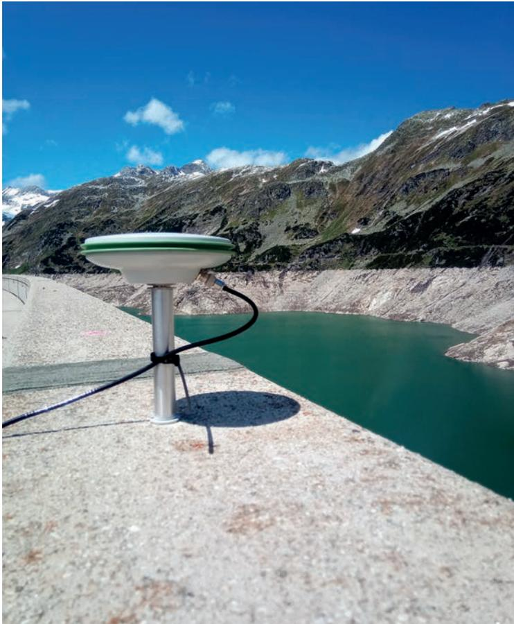
Eine Messantenne auf der Kölnbreinsperre.
