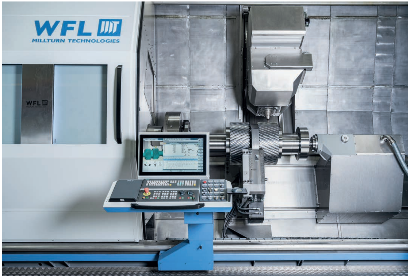
M80X Millturn mit 4.500 mm Spitzenweite bei der Bearbeitung einer Getriebewelle.
