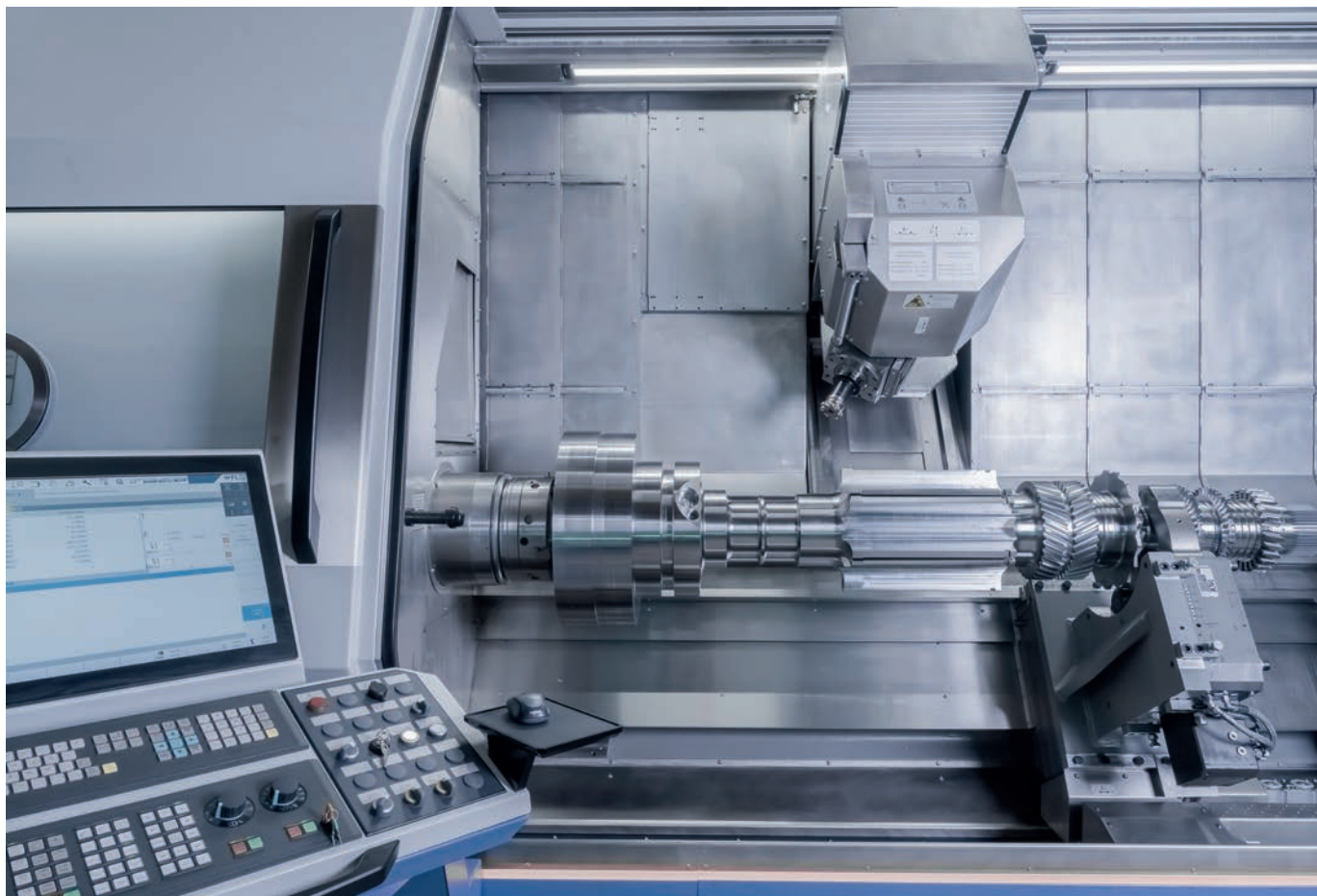
Power Generation Shaft: Das 2.355 mm lange und 1.082 kg schwere Werkstück wird auf einer M50 Millturn/3.000 mm bearbeitet.
