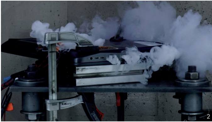
Ausgasen einer Laptopbatterie während des thermischen Durchgehens (li.). Brand eines Laptops während des thermischen Durchgehens (re.).
