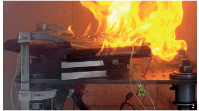
Ausgasen einer Laptopbatterie während des thermischen Durchgehens (li.). Brand eines Laptops während des thermischen Durchgehens (re.).
