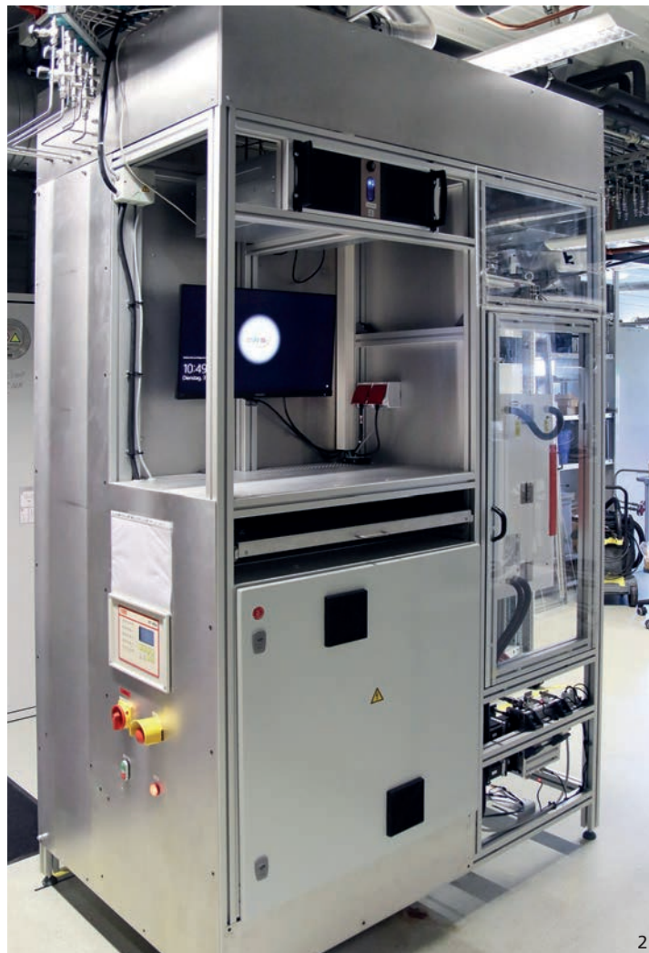
Direktreduktionsanlage im Labormaßstab für reaktionskinetische Untersuchungen und Modellierung des Schachtofens
