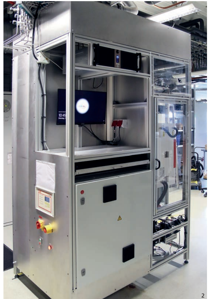
Direktreduktionsanlage im Labormaßstab für reaktionskinetische Untersuchungen und Modellierung des Schachtofens
