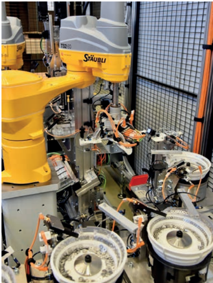
Die Stäubli-Scaras müssen in der Anlage eine Vielzahl von Handhabungsaufgaben hochpräzise, schnell und zuverlässig erledigen.
